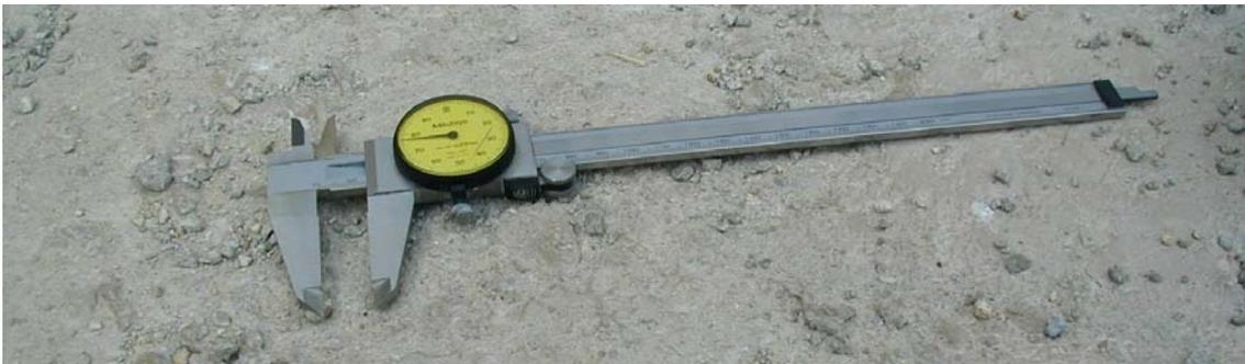
**Figura 42: Calibre con micrómetro para lectura de centésimas de milímetro (U&A).**
